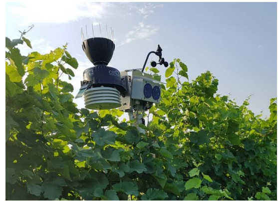
Figura 1 Un innovativo sistema di gestione dell'irrigazione in vigneto, basato su multisensoristica.
